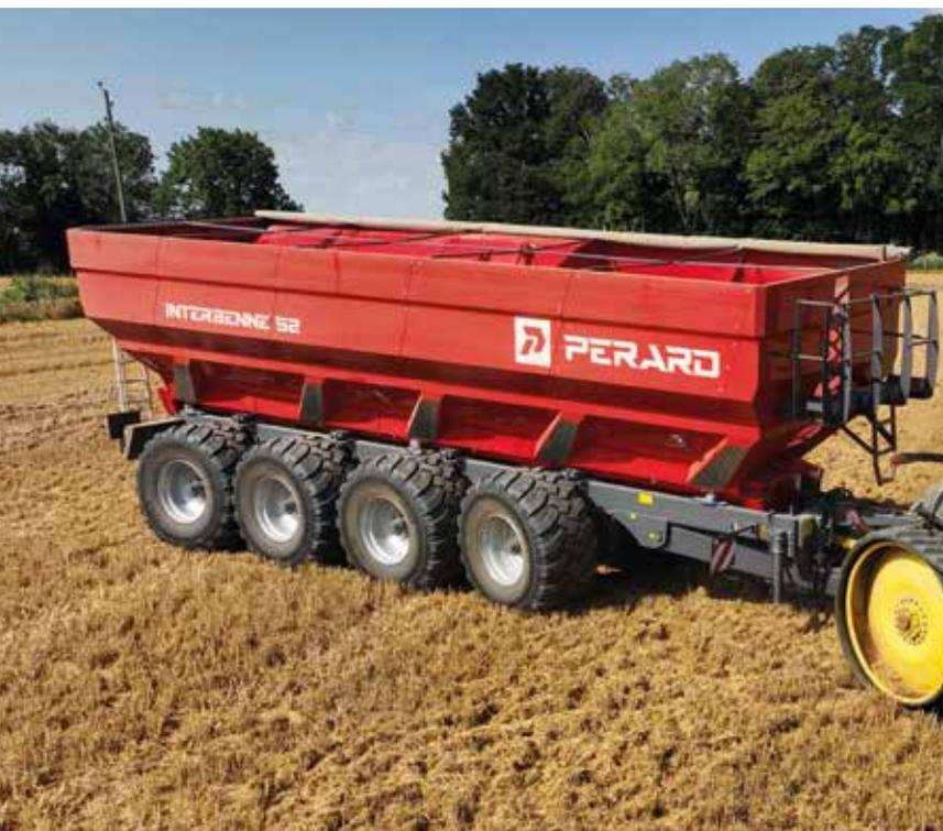
I coni azionati idraulicamente all'interno del corpo consentono di chiudere completamente la coclea inferiore. Regolano quindi il flusso o lo arrestano completamente. Ideale per il rabbocco di un camion o per ridurre il flusso quando si utilizza un fertilizzante. Un indicatore di livello sulla parte anteriore della macchina indica l'altezza di apertura dei coni sulla coclea inferiore.
