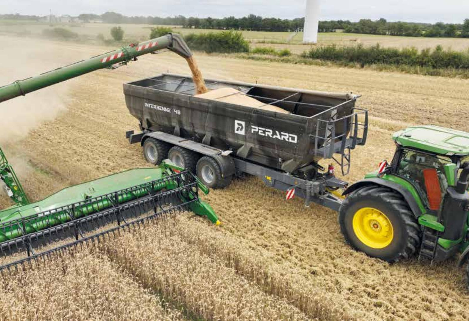
Le Interbenne 46 e 52 sono dotate di una coclea di scarico con un diametro di 700 mm nella parte inferiore e di 600 mm nella parte superiore. Grazie a questo ingegnoso design, l'Interbenne può raggiungere una produttività di 2.000 t/ora, ovvero 46 m<sup>2</sup> in 1 minuto.
