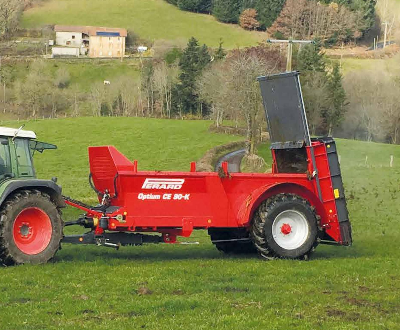
Gli spandiletame della serie Optium K hanno una capacità da 9 a 13 m<sup>3</sup>. Sono dotati di rotori a doppia spirale da 750 mm di Ø. Con un'altezza di carico di soli 1,85 m per il modello CE 90K, il loro design extra-ribassato li rende tra le macchine più basse del mercato, adatte alle aree con pendenze elevate.
