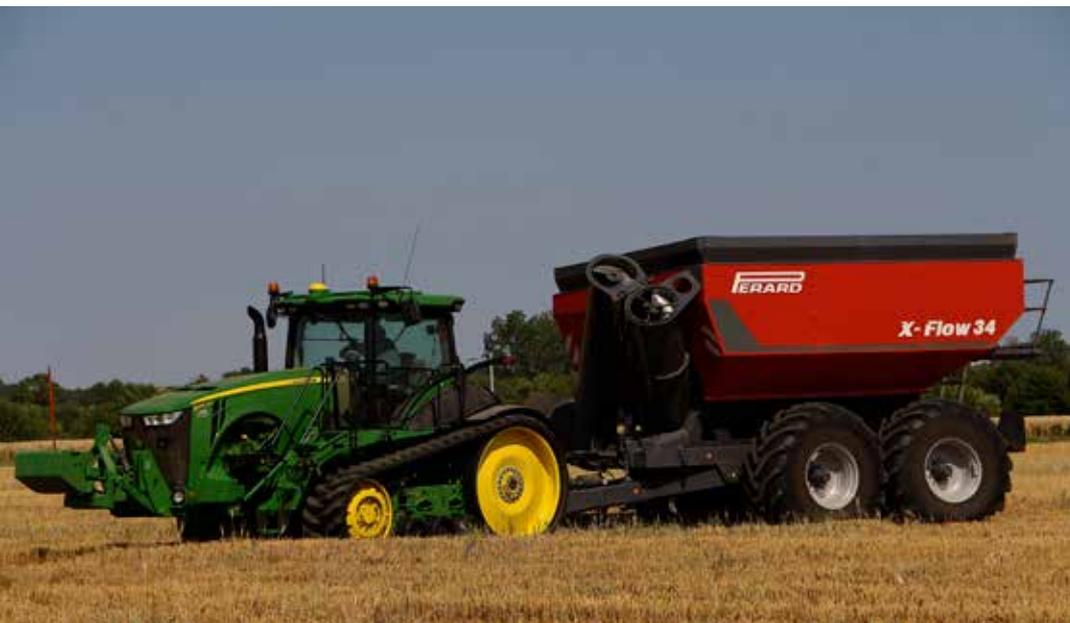
Sui modelli X-Flow 28 e 34, una coclea idraulica consente di svuotare completamente il cassone, con la stessa portata dall'inizio alla fine. La carreggiata larga 3,5 m consente di non seguire la carreggiata del trattore e garantisce un'eccezionale stabilità.
