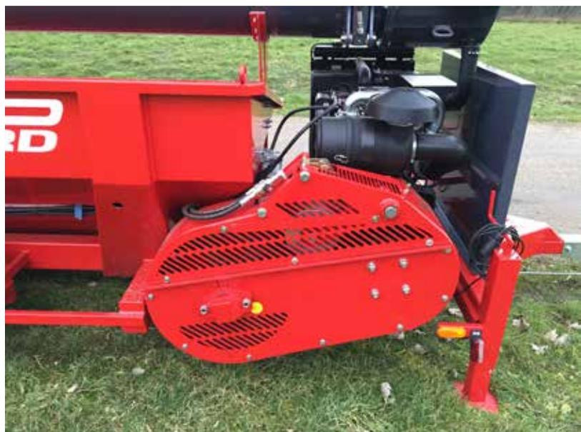
Para lugares separados por varios kilómetros, la Trans-eXpress puede equiparse opcionalmente con un motor térmico autónomo con depósito, embrague y controles hidráulicos.
