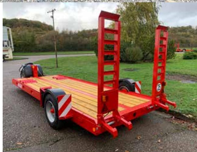
Las plataformas basculantes y los porta-coches se pueden enganchar fácilmente gracias a su brazo telescópico con bloqueo automático. Su diseño simple no requiere elevación ni caudal de aceite. De esta manera, se pueden enganchar detrás de un tractor, una cosechadora o una picadora de forraje.
