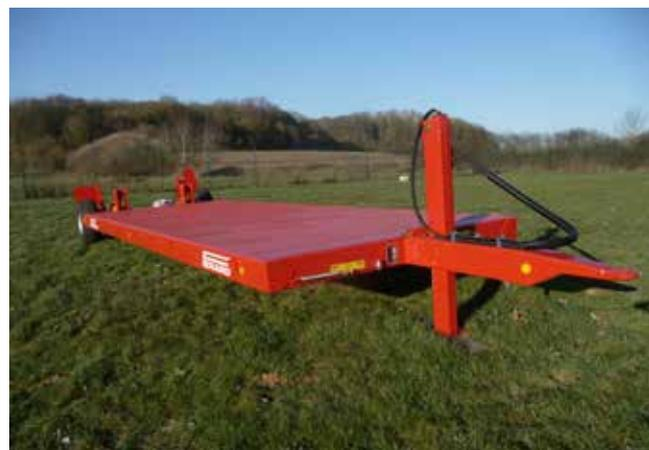
Standardmäßig sind alle Stützbeine hydraulisch. Der Zylinder befindet sich im Inneren des Stützfußes. Sobald die Plattform auf dem Boden steht, kann die Stütze vollständig eingeklappt werden, so dass sie in Verlängerung des Auslegers liegt. So ist es möglich, eine fahrende Maschine von vorne zu beladen.
