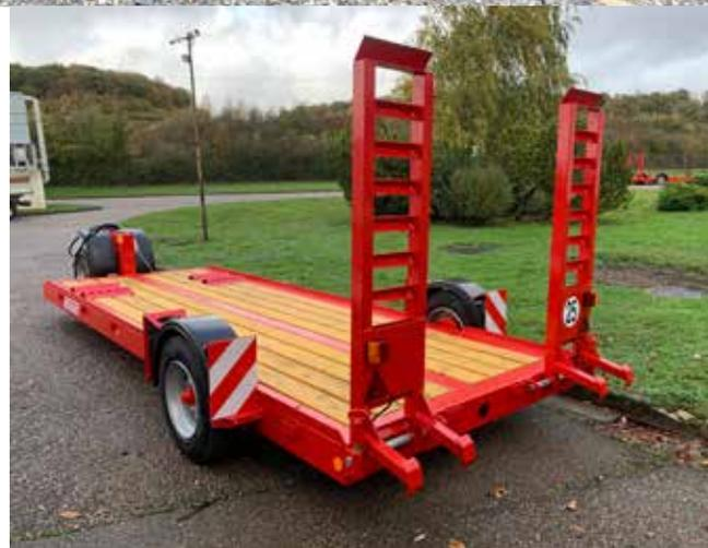
Die neigbaren Pritschen und Autotransporter sind mit ihrem selbstverriegelnden Teleskopausleger einfach anzukoppeln. Ihre einfache Konstruktion erfordert weder einen Kraftheber noch einen Ölschluss. Sie können daher hinter einem Traktor, Mähdrescher oder Feldhäcksler angehängt werden.
