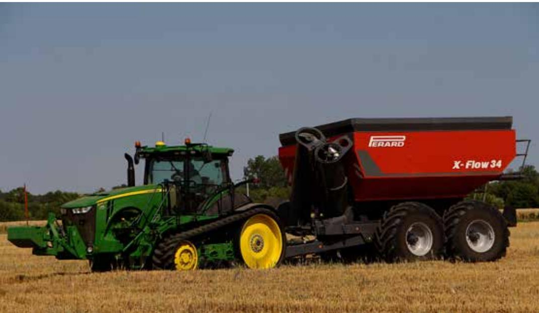
Bei den X-Flow 28 und 34 ermöglicht eine hydraulische Bodenschraube das vollständige Entleeren des Kastens, wobei der Durchfluss vom Anfang bis zum Ende der Entleerung gleich bleibt. Die 3,50 m breite Spur sorgt dafür, dass der Traktor nicht in die Spur gerät und bietet eine außergewöhnliche Stabilität.
