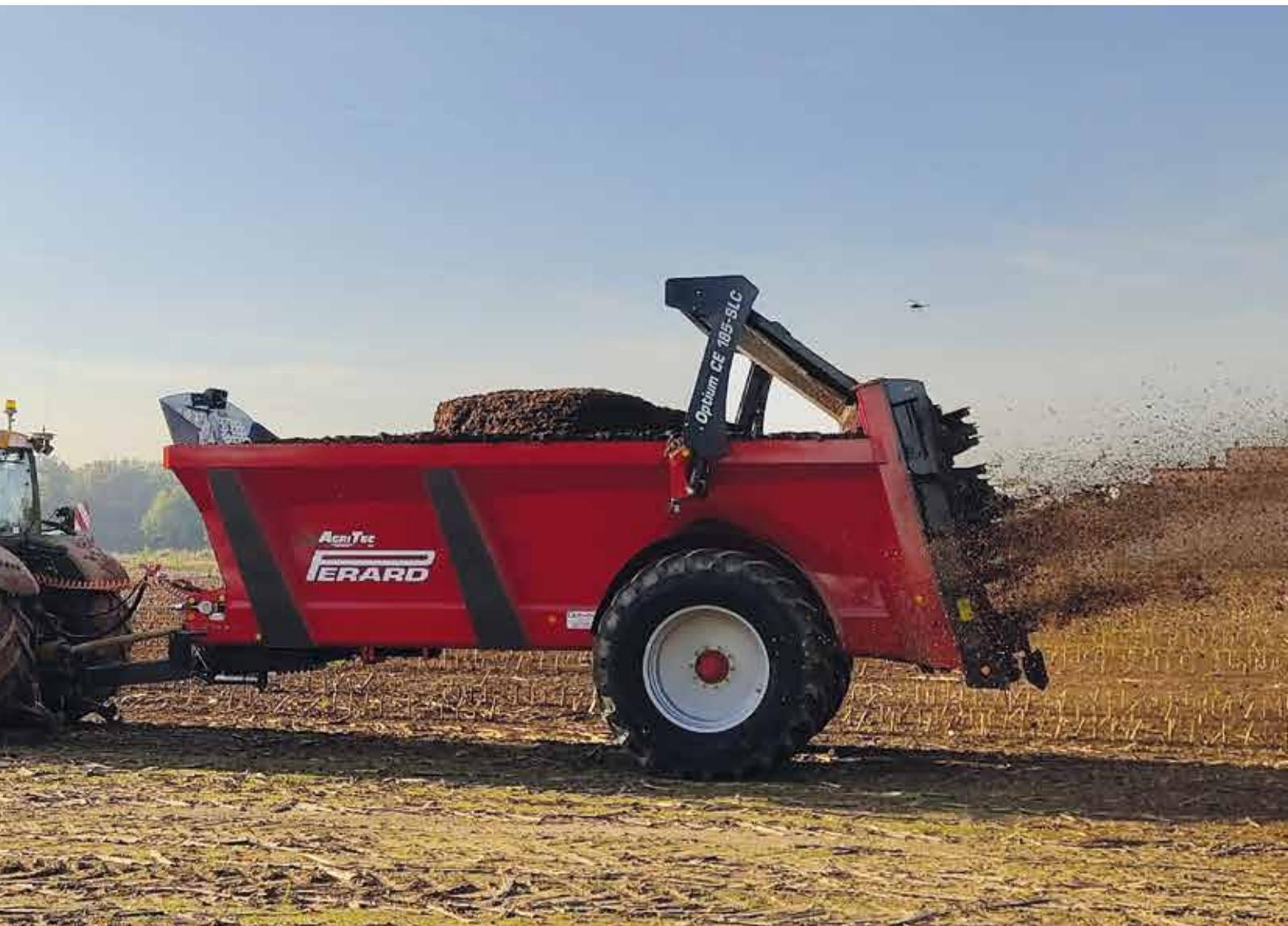
Optional können die 1050er Igel mit einer ausklappbaren Heckflosse ausgestattet werden, um zu verhindern, dass feines Material zu einem Schwad wird.
