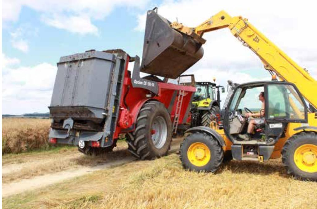
Die Optium SLC-Streuer sind in Größen von 16 bis 18 m<sup>3</sup> erhältlich. Ausgestattet mit dem unnachahmlichen Doppelspiralstriegel können sie alle Arten von Dung und sogar Kompost auf einer unübertroffenen Breite und Feinheit verteilen. Diese Exklusivität wird durch die Kombination von Messern und Wurfschaufeln erreicht. Die Messer zerkleinern den Dung und die Wurfschaufeln werfen ihn aus.
