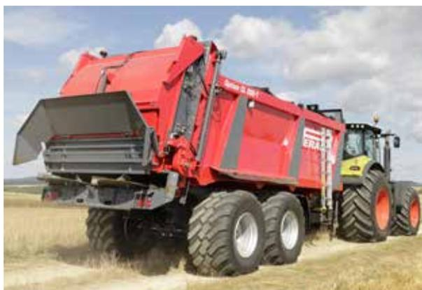
Die geniale Konstruktion des Pérard-Streutellers, ermöglicht es dem Band, das Streugut praktisch in der Mitte der Scheiben abzulegen, wie bei einem Düngerstreuer. Daraus ergibt sich eine große Arbeitsbreite und die Möglichkeit, eine Vielzahl von Produkten (Kompost, Mist, Kalk, ...) zu streuen.
