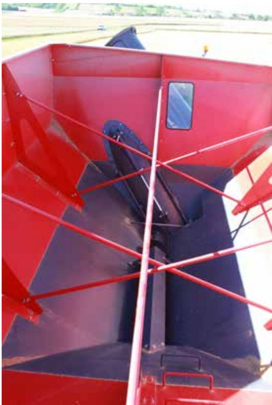
Das konische Gehäuse der X-Flow ermöglicht eine leichtere Reinigung. Der Abstand zwischen dem Lkw und der Föhre wird durch den Ausklappwinkel der Schnecke vergrößert. Diese Konstruktion sorgt für eine gute Sicht während des Entleerens.
