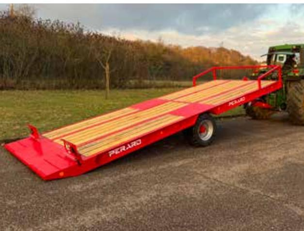
Pritschenfahrzeuge des Typs PORTE CHARS, die für den Transport von Raupenfahrzeugen oder nicht für den standardisierten Straßenverkehr zugelassenen Fahrzeugen (Raupen- oder Mobilbagger, Skidder, Traktoren ...) bestimmt sind.
