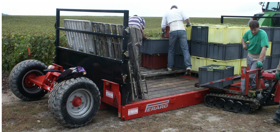
Facilité de chargement (hauteur plancher à 0,25 m)
