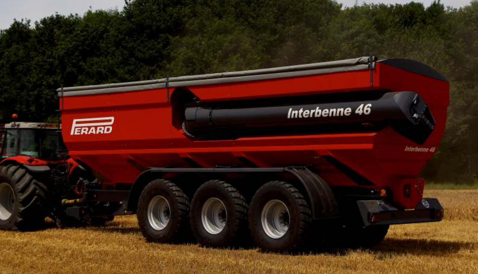
Interbenne 46 mit Reifen 850/50 R 30.5
